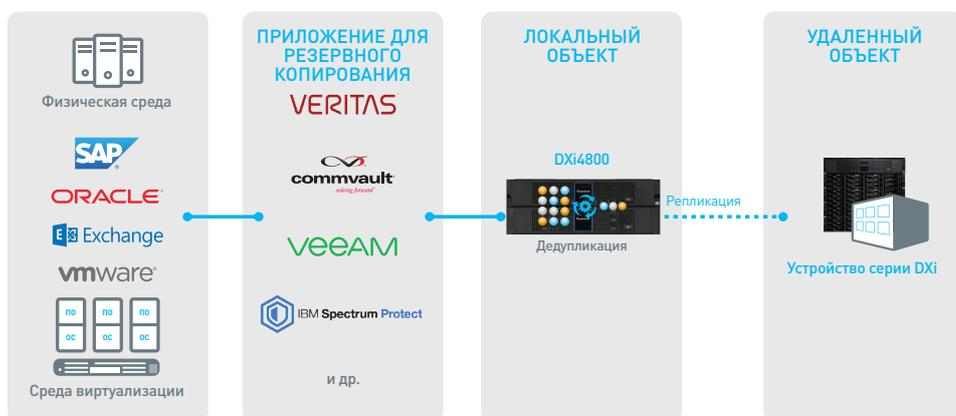
Рис. 1. Репликация резервных данных для автоматической защиты на случай сбоев
